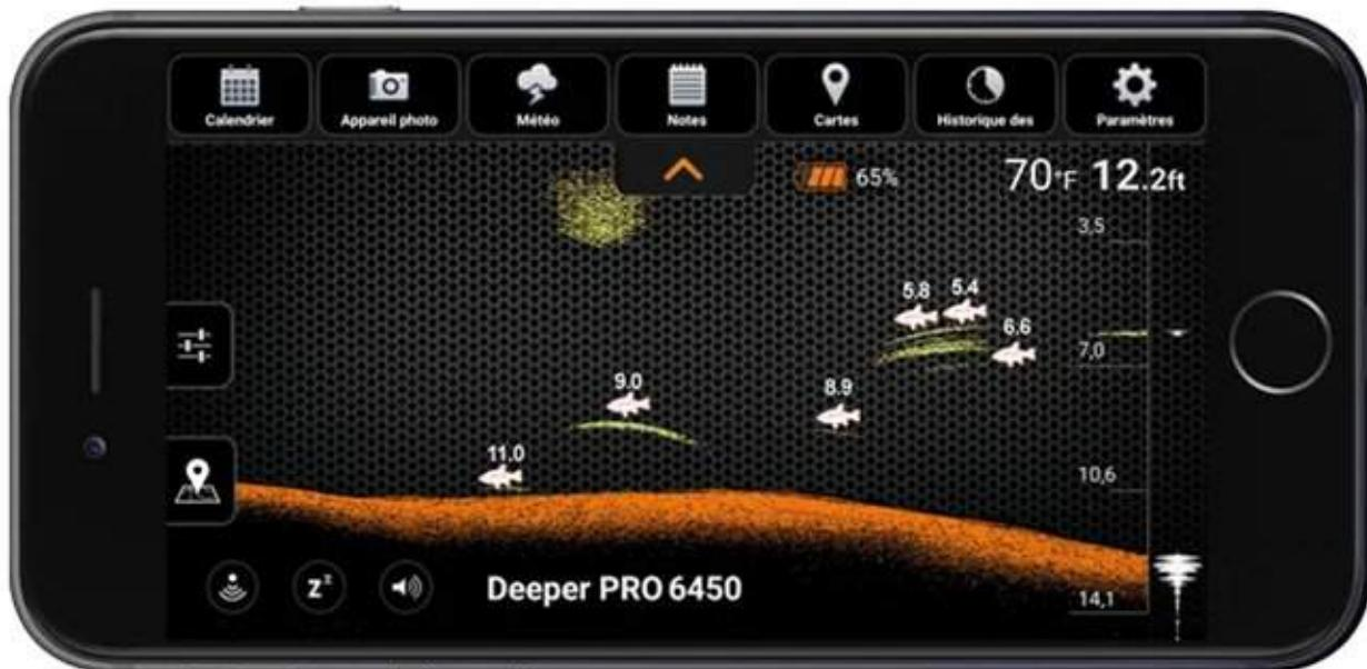
**水底：**詳細スキャンに設定すると、水底が硬いのか柔らかいのかを判断するのに役立ちます。Deeperから送信されたソナーパルスが底部で反射されると、硬い底部は柔らかい底部よりも強い信号を返します。
