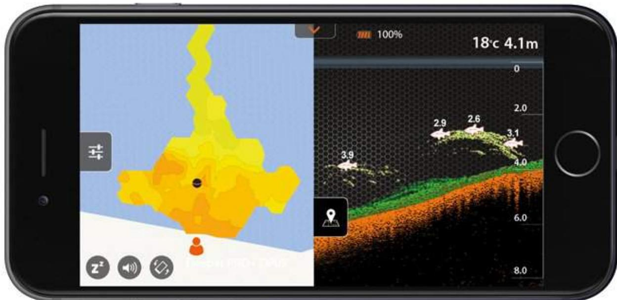
DeeperPROまたはPRO +を使用している場合は、マッピングの精度を高めるためにナロービーム（290 kHz）を使用することをお勧めします。
