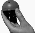
2. デバイスとカバーの防水マークが合うようにナイトフィッシングカバーをしっかりを締めてください。
